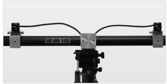
Abbildung 5: Für Hochgeschwindigkeitsanwendungen können auch Video-Kameras eingesetzt werden.
